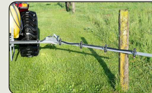
Boom breakaway protection - boom snaps back unharmed
